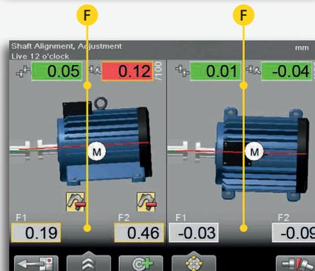
3. «Живые» значения отображают изменение центровки при наладке машины. Для наглядности значение центровок показывается как графически, так и в численном виде. Горизонтальная и вертикальная плоскость выводятся на дисплей одновременно.
