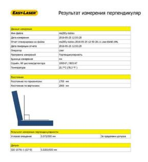
7. Перпендикулярность хода пиноли в вертикальном направлении относительно поворотного стола в плоскости Y-Z (база стола 2000 мм, ход пиноли в направлении Y 2000 мм)
