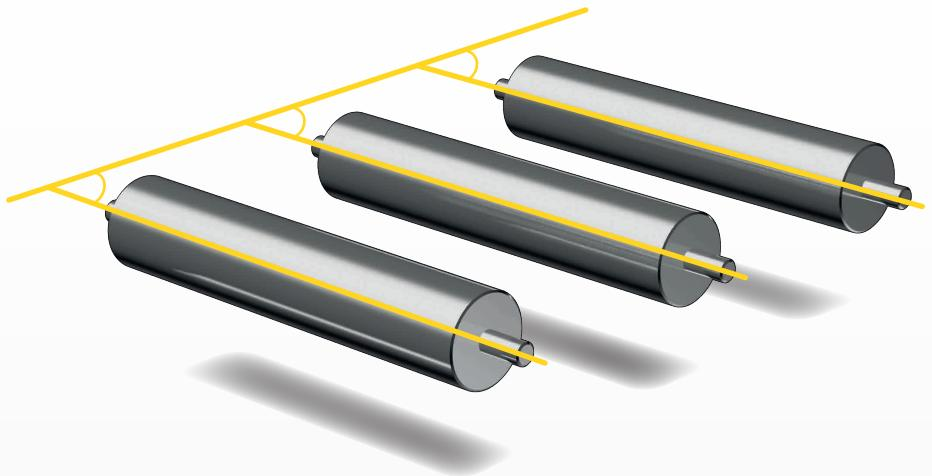
Вращающиеся валы, цилиндры, ролики – наиболее типичный пример узлов машины, параллельность которых чрезвычайно важна для обеспечения максимальной производительности оборудования. Ниже показано еще несколько примеров.
