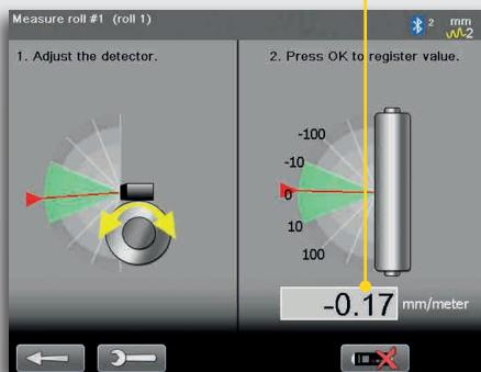
2. С помощью детектора измерьте горизонтальный угол (отклонение в горизонтальной плоскости), зарегистрируйте полученное значение и получите корректировки (A).
