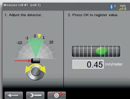
1. Зарегистрируйте вертикальный угол (наклон) с помощью цифрового прецизионного уровня.
