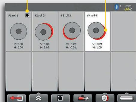
3. Результаты проверки всех валков отображаются в виде графика или таблицы (Б). Отметка объекта, используемого в качестве базы для измерений (Б). Графическое представление положения валка. (Также см. выше результаты для E970 с другим примером отображения данных.)
