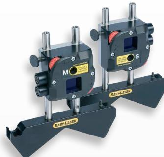
Имеется несколько моделей измерительных блоков для центровки валов. В данном случае изображены двухкоординатные лазерные блоки.
