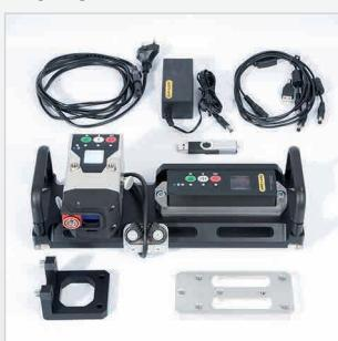
Полный комплект с кронштейном, детектором E2, цифровым прецизионным уровнем E290, зарядным устройством и кейсом для переноски. Номер по каталогу: 12-0856.
