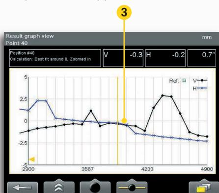
Результат отображается как «Наилучшее расположение вокруг 0» (З) с точным графиком.
