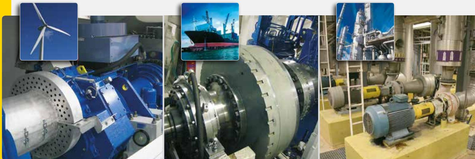
Система Easy-Laser® применяется для центровки ветрогенераторов различных размеров и модификаций. В целях повышения безопасности оператора для центровки валов с заторможенными роторами разработаны специальные кронштейны.
