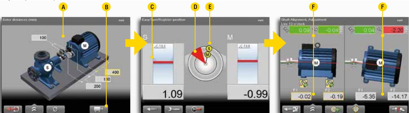
**1.** Введите расстояния между измерительными блоками и опорами машины. Если Вы укажете диаметр муфты, то результаты будут содержать значение зазора / раскрытия.
